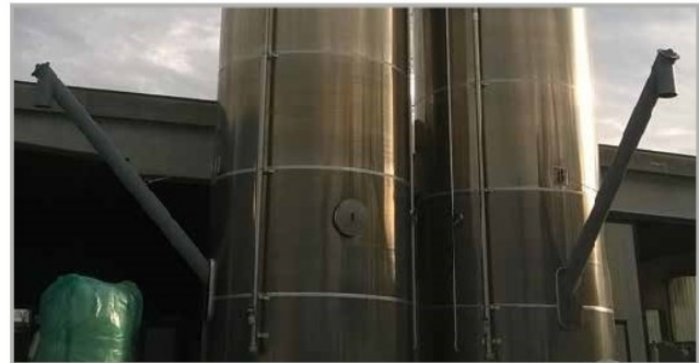
COCLEE TUBOLARI ESTRATTRICI DA SILOS TUBULAR DISCHARGE SCREWS FROM SILOS
