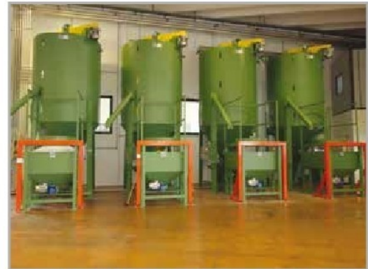
MESCOLATORI A COCCIA CON TRAMOGGIA DI CARICO FORZATO PER CARICO DA BIG-BAG SCREW MIXERS WITH FORCED LOADING HOPPER FOR LOADING FROM BIG-BAG
