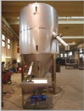
MESCOLATORE INOX 1400 L CON CARICAMENTO FORZATO 1400 L STAINLESS STEEL MIXER WITH FORCED LOADING
