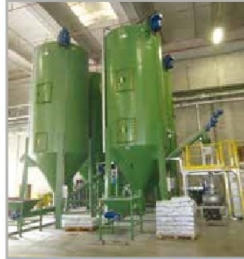
IMPIANTO DI MISCELAZIONE CENTRALIZZATO CON TRASPORTO A COCCIA CENTRALISED MIXING PLANT WITH SCREW CONVEYOR
