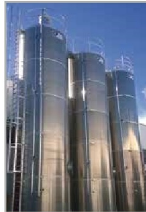
SILOS E STRUTTURA SU CELLE DI CARICO SILOS AND FRAME ON LOAD CELLS
