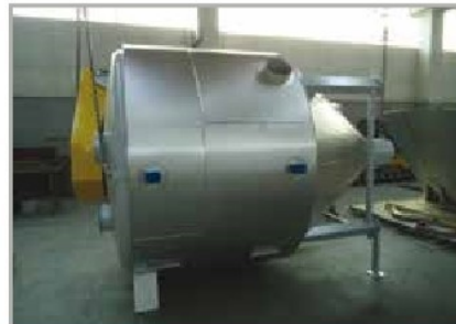
MESCOLATORE COIBENTATO CON SISTEMA DI PRERISCALDO INSULATED MIXER WITH PREHEATING SYSTEM
