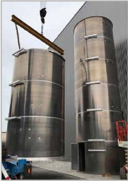
SILOS ESTENSIBILE PER OTTIMIZZARE TRASPORTO SU NAVE EXTENSIBLE SILOS TO OPTIMIZE SHIP TRANSPORT
