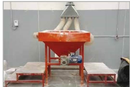
STAZIONE DI CARICAMENTO POLVERI ASPIRATA E TRASPORTO TRAMITE COCLEA POWDER SUCTION LOADING STATION AND SCREW CONVEYOR
