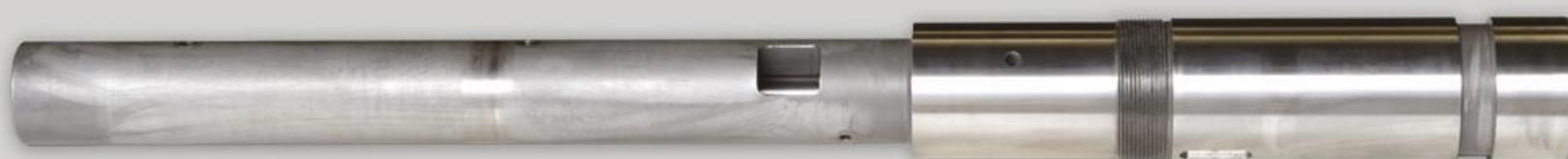
I cilindri di plastificazione, così come le viti, sono parti soggette ad usura per abrasione e/o corrosione. Per questo motivo è utile, anche in questo caso, scegliere con accuratezza il materiale di costruzione più idoneo.
